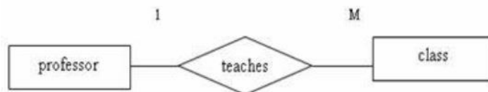
ภาพที่ 2.7 ความสัมพันธ์แบบ One to Many Relationships
